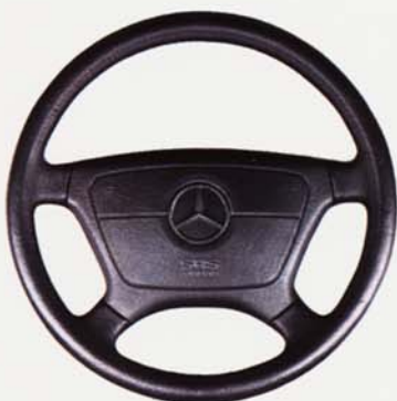
Verborgen im Lenkrad: der serienmäßige, große Fahrer-Airbag. Wenn Sie ihn brauchen, bläst er sich in 0,03 Sekunden auf.
