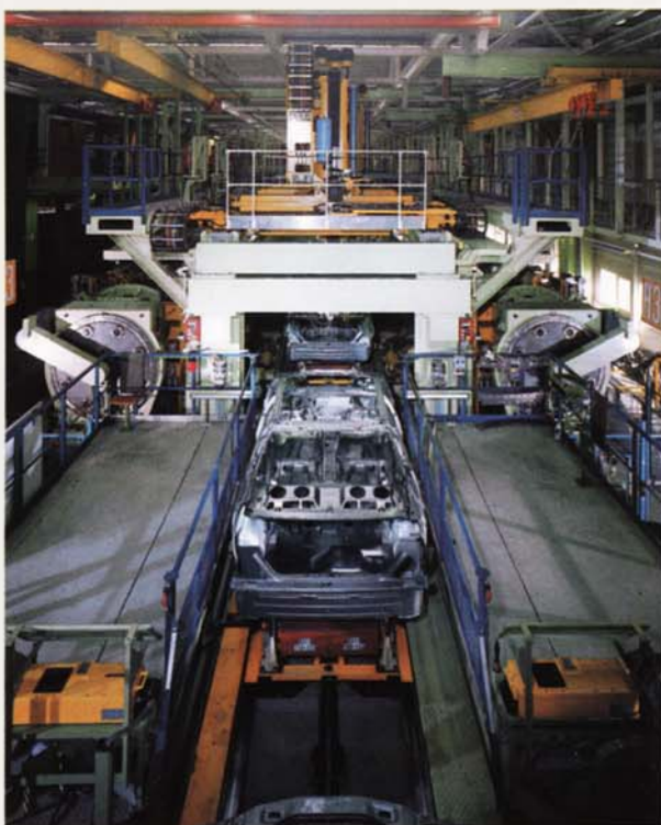
Eine variable Produktionsstraße für die Pkw-Karosserie- montage in unserem Werk Sindelfingen bei Stuttgart.
