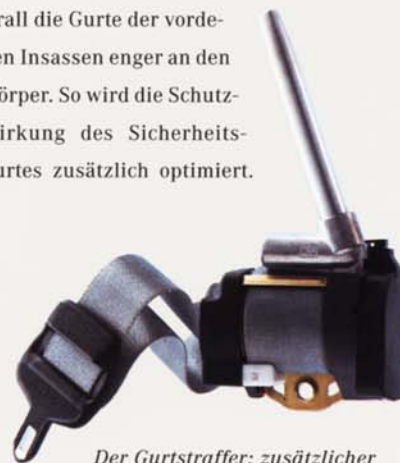
Der Gurtstraffer: zusätzlicher Schutz bei einem Unfall.
